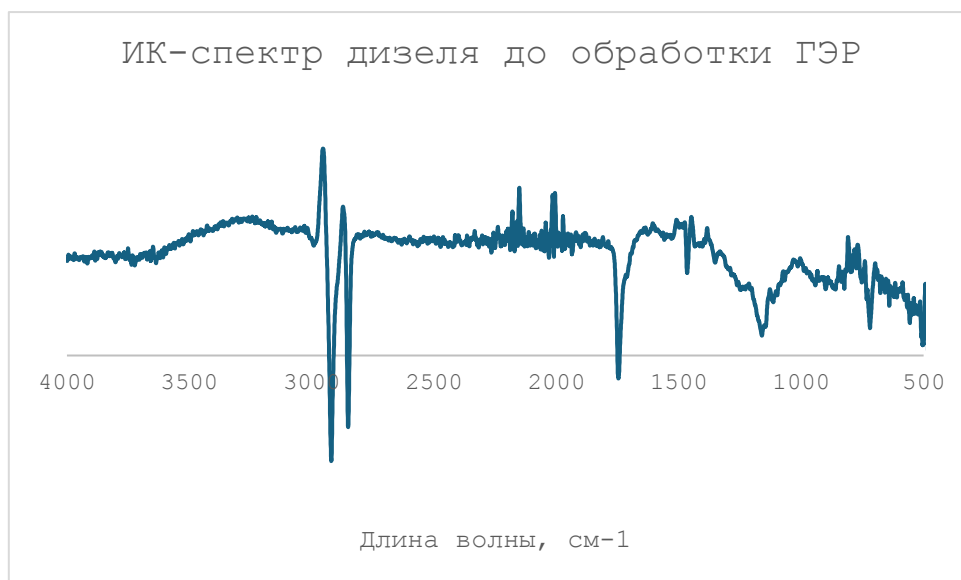
Рисунок 16 - ИК спектр дизельного топлива до смешивания (EXCEL)
